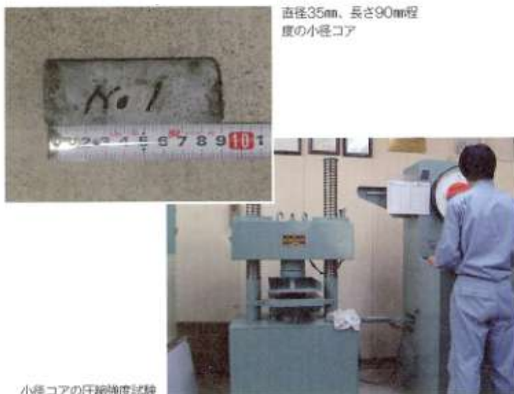
小径コアの圧縮強度試験
