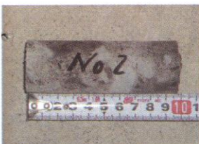
抜き取ったコア。直径4φに満たず、建物に与える傷は小さく済む
