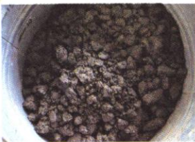
小樽港防波堤(築造100年以上が経過した今も現役)をつくるのに使用したコンクリートを再現したもの。砂利が非常に多いことが分かる
