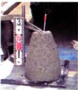
生コンの流動性を確認するためのスランプ試験。固い生コンであるほど、高い山ができ、崩れにくい
